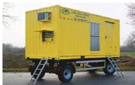
Пример стационарной лаборатории для термической обработки мощностью 216 кВт на базе блок-контейнера на шасси с дизельным генератором, нагревательной установкой, кондиционером и складским помещением.
