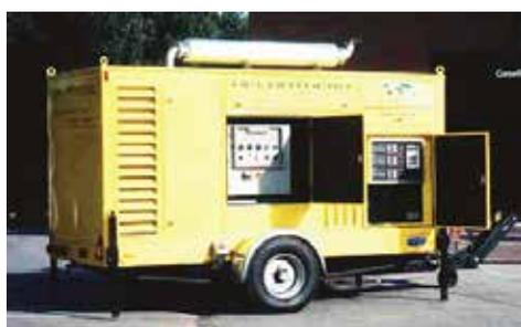
Пример автономной нагревательной установки с дизельным генератором на шасси прицепа
