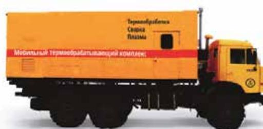
Пример автономной нагревательной установки с дизельным генератором в кунге автомобиля
